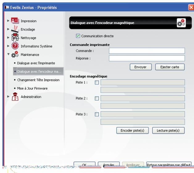
En allant dans **Maintenance** puis sur **Dialogue avec l'encodeur magnétique**, l'**Encodage magnétique** permet l'encodage direct d'une ou des pistes magnétiques à partir de cette fenêtre simplement en les sélectionnant et en entrant les données à encoder. Cliquer sur le bouton **Encoder piste(s)** pour lancer le cycle d'encodage.
