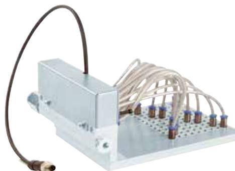
Für das schnelle Etikettieren in Echtzeit auf Verpackungen oder Produkten im Durchlauf. Die Etikettierung erfolgt bevorzugt von oben. Die Etiketten werden von einem Lüfter angesaugt und von einem kräftigen Luftstoß durch ausgerichtete Düsen abgeblasen. Der Abstand von der Geräteunterkante bis zum Produkt beträgt je nach Etikettengröße bis 100 mm.
