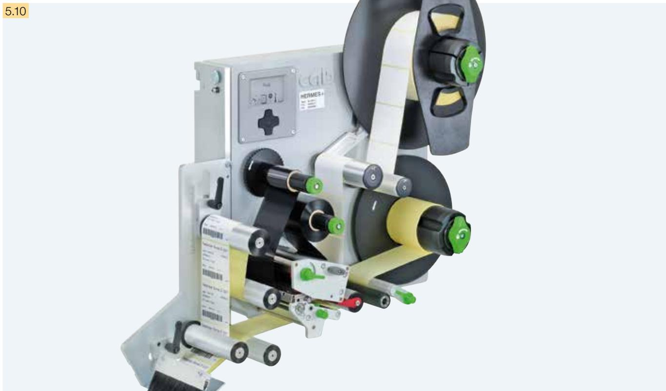
Für die Serienetikettierungen von Verpackungen im Durchlauf. Mit der verstellbaren Umlenkrolle wird die Etikettenposition an der Spendezunge eingestellt. Die Etikettierung kann von allen Seiten vorgenommen werden. Während des Spendevorgangs wird gleichzeitig das nächste Etikett gedruckt. Die Geschwindigkeit des Transportbandes muss der Druckgeschwindigkeit angepasst werden.
