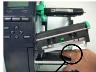
Prenez garde à ce que des objets métalliques comme une bague ne rentrent pas en contact avec l'arête de la tête d'impression.
