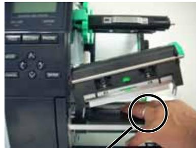
Ne laissez d'objet métallique tels une bague toucher la tête d'impression.
