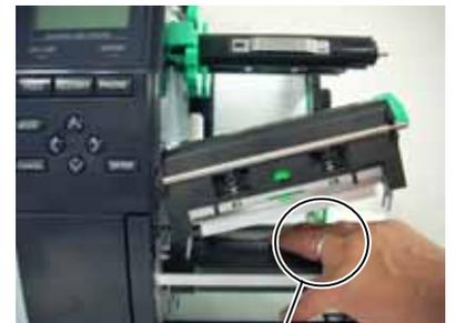
Prenez garde à ce que des objets métalliques comme une bague ne rentrent pas en contact avec l'arête de la tête d'impression.
